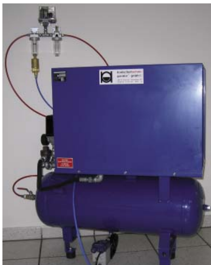
Kompresor vzduchu s tlumením hluku
