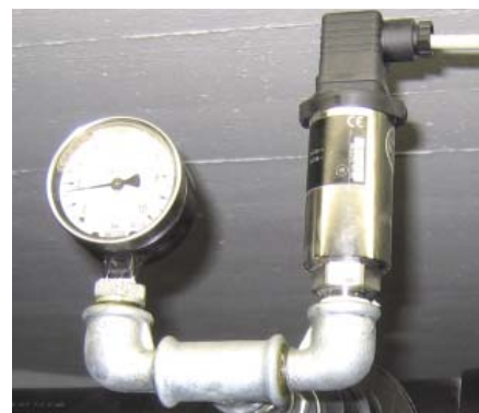
Optimální měření tlaku v potrubí
