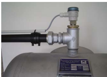
Kapacitní měření plnění
